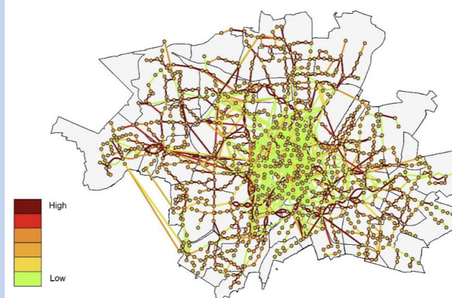
Een voorbeeld van analyse van een openbaarvervoersnetwerk met de SmartHubs Resilience Tool
